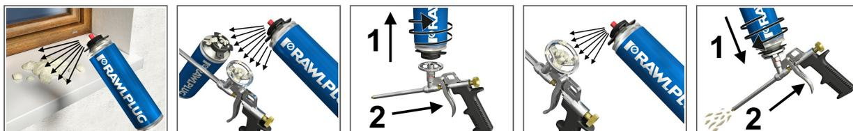
1. Очистка поверхности: - Наложить на клапан банки с чистящим веществом распылительный наконечник - Спрыскать чистящим веществом свежие загрязнения - При очистке загрязнённого клапана ёмкости с полиуретановой пеной тщательно распылить чистящим вещество на затвор и переходник пистолета - Удалить загрязнения сухой тряпкой
