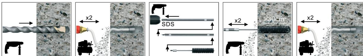
1. Просверлить отверстие необходимого диаметра и с соответствующей глубиной.
