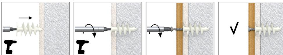
1. Вкрутить дюбель ISO-PLUG в теплоизоляционный материал (отверткой или шуруповертом) до момента его прочного закрепления
